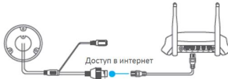
Рисунок 5-3 Подключение к роутеру
